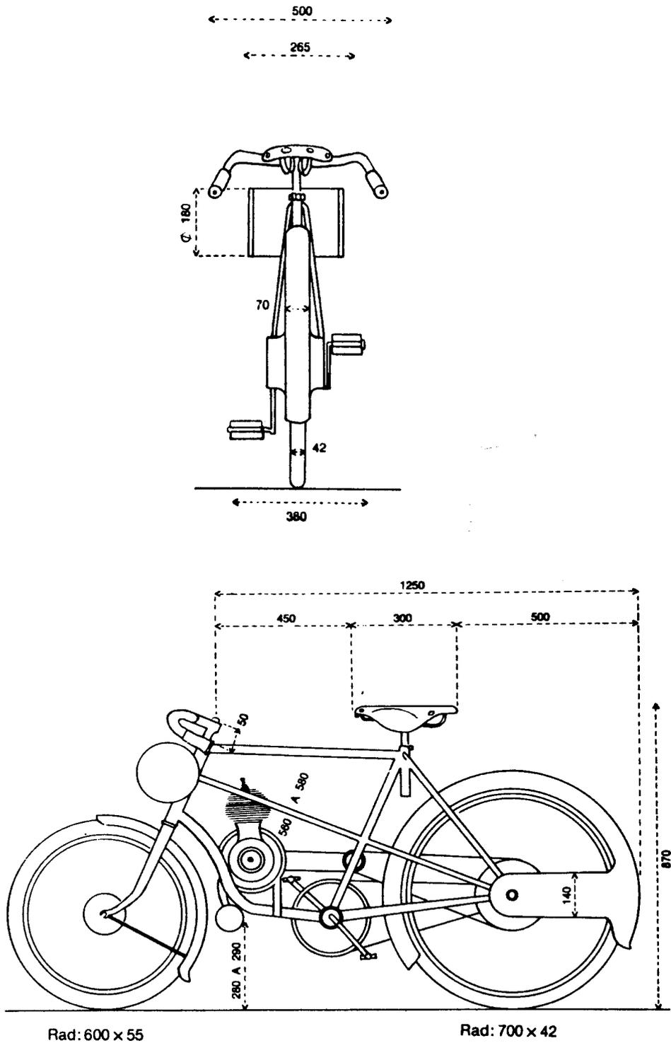
(1) Die Konstruktion dieser Maschinen entspricht einem Kleinmotorrad mit zusätzlichem Pedalantrieb (siehe obenstehende Abbildungen):
